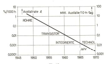
Fig. 15 Ausfallrate λ, mittlere Ausfälle/10-Std.-Tag für 100 000 Bauelemente
