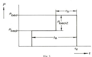
Kenngrössen des zweistufigen Belastungsmodells eines Abnehmers nach [12]
