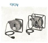
belauszug-Arretierung mittels federnder Klinke. In Befestigungsbügel drehbar gelagerte Rückzugkabelrolle mit festem Netzanschluss. Freies Ende des ausziehbaren Kabels mit Kupplungssteckdose 2 P+E, Typ 14. Die Rückzugkabelrolle mit Traggestell wird mit dem ausziehbaren Kabel mit Stecker Typ 12 am Netz angeschlossen. Anschluss des Verbrauchers an eingebauter Steckdose 2 P+E Typ 14.
