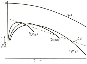
Fig.~3 Rendement des adductions  $\eta_{add}$  (galerie et conduite forcée) et rendement général  $\eta_{g}$  lorsque tous les groupes en service fonctionnent à la même puissance
