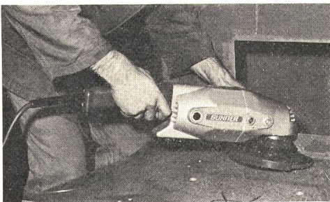
Fig. 1 Winkelschleifer WWJ 6 220 V, 100 W im Betrieb mit Schruppscheibe 178 mm \phi
