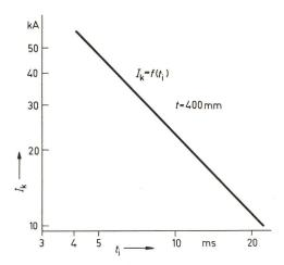
Fig. 11 Berührungszeit  $t_{\rm i}$  in Funktion des Kurzschlußstromes  $I_{\rm k}$  t Teilleiterabstand
