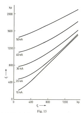
Totale Seilzugkraft  $F_{\rm t}$  pro Teilleiter in Funktion der statischen Seilzugkraft  $F_{\rm S}$
