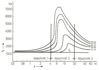
Fig. 6 Totale Seilzugkraft  $F_{\rm t}$  pro Teilleiter in Funktion der Teilfeldlänge s Parameter: Kurzschlußstrom  $I_{\rm k}$  (t = 400 mm,  $F_{\rm s}$  = 1200 kp);  $F_{\rm s}$  statische Seilzugkraft
