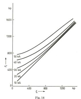
Totale Seilzugkraft pro Teilleiter  $F_{\rm S}$  in Funktion der stat. Seilzugkraft  $F_{\rm t}$  Parameter: Kurzschlußstrom  $I_{\rm k}$  ( $s=1000~{\rm mm};~t=400~{\rm mm}$ )
