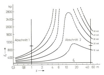
$\begin{array}{c} {\rm Fig.~10} \\ {\rm Totale~Seilzugkraft~}F_{\rm t}~{\rm pro~Teilleiter~in~Funktion~der~Teilfeldlänge~}s \\ (t=400~{\rm mm,~}F_{\rm s}~100~{\rm kp}) \\ {\rm Weitere~Bezeichnungen~siehe~Fig.~6} \end{array}$
