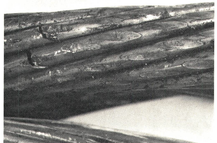
Fig. 5 Schwingungsbrüche und Druckellipsen
