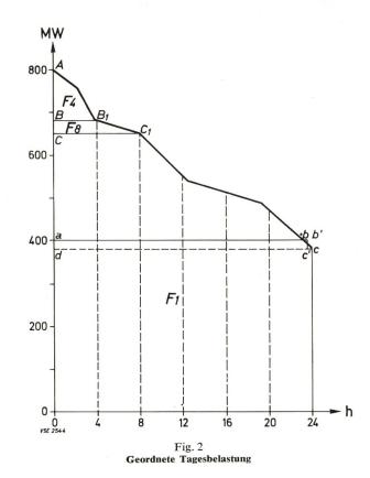
Grössen — also auch die täglichen Ausnützungsstunden — erkennen. Durch den willkürlich gewählten Punkt  $O_2$  wird eine Parallele zur Abszissenachse gezogen und der lineare Stundenmaßstab eingezeichnet (der Punkt 24 ergibt sich aus der Verlängerung des geraden Teiles der Energieinhaltslinie).
