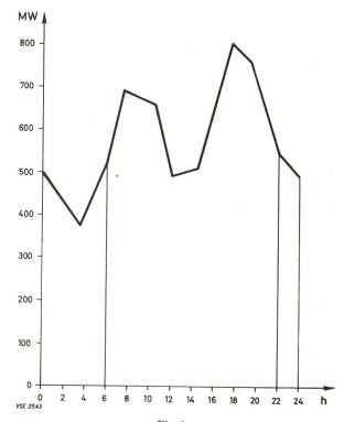
Fig. 1 Zeitlicher Ablauf einer Tagesbelastung
