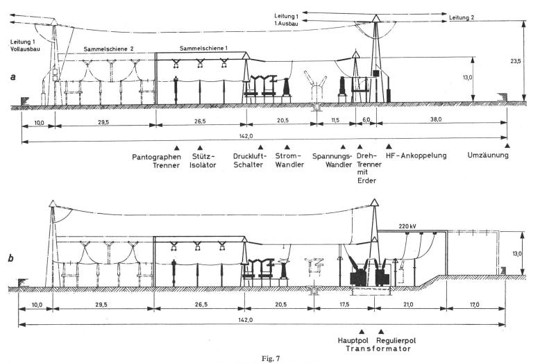
Disposition der 400-kV-Schaltfelder
