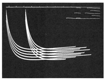
Fig. 10 Reihenaufzeichnung des Spannungsverlaufes zwischen Stab—Stab bei 1,2 m Schlagweite und Welle  $200\,|\,4000\,$  µs neg. Polarität Zeiteichung  $100\,$ µs
