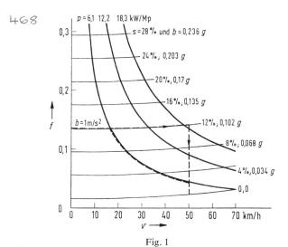
Relatives Schubverhalten f eines Strassenfahrzeuges mit Radleistung p für verschiedene Steigungen s und Beschleunigungen b in Abhängigkeit von der Fahrgeschwindigkeit p
