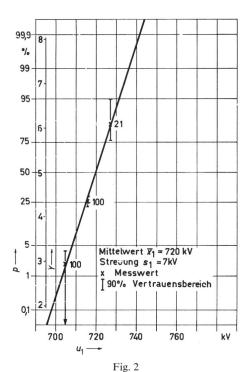
Durchschlagwahrscheinlichkeit p in Funktion der Spannung u<sub>2</sub> bei einem Kugeldurchmesser von 2000 mm
