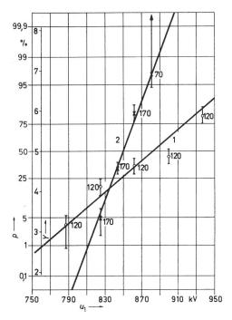
$Fig.~6 \\ Durchschlagwahrscheinlichkeit in Funktion der Spannung bei Welle \\ 200 |~4000~\mu_S~neg.~Polarität$
