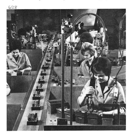
Fig. 2 Montageband Kleinautomaten
