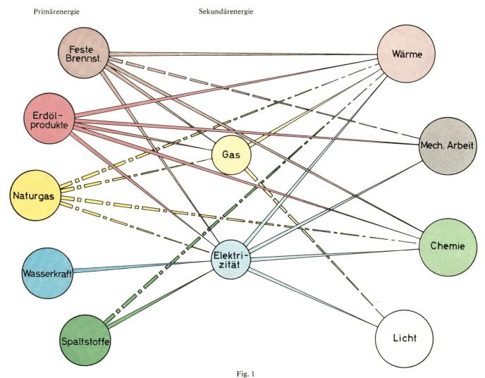
Anwendungsmöglichkeiten der Primär- und Sekundär-Energieträger für die Deckung des Nutzenergiebedarfes
