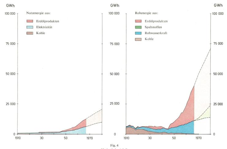
Mechanische Arbeit Nutzenergiebedarf für die Erzeugung von mechanischer Arbeit und Deckung durch Rohenergie Verteilung nach Primär- und Sekundär-Energieträgern
