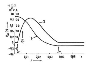
Berechneter Spannungs- und Stromverlauf an einem Kaskaden-Spannungswandler bei der Entladung einer 700-kV-Leitung Es wird die erste Halbwelle gezeigt
