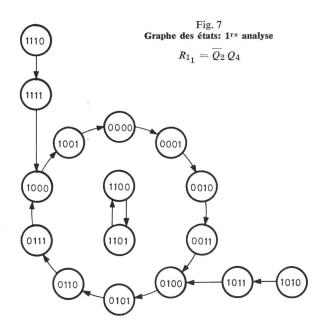
dans l'état 1100 (respectivement 1101) alors il sera conduit dans l'état 1101 (respectivement 1100), et reviendra ensuite dans sa position initiale en parcourant ainsi une séquence de deux états non désirée ou «séquence parasite». Il est primordial de détecter de telles situations dont les conséquences peuvent être fâcheuses pour le compteur ainsi synthétisé.
