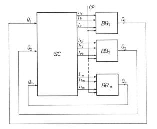
Fig. 2 Schéma-bloc du compteur synchrone
