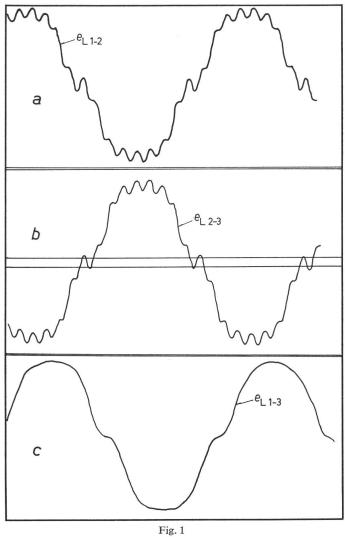
Oszillogramme von Lamellenspannungen ohne aufgesetzte Bürsten a Lamellenspannung  $e_{\rm L~1-2};\ b$  Lamellenspannung  $e_{\rm L~2-3};\ c$  Lamellenspannung  $e_{\rm L~2-3};\ c$
