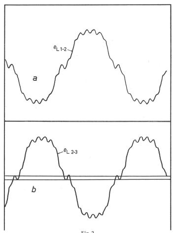
Fig. 2 Oszillogramme von Lamellenspannungen mit aufgesetzten Bürsten a Lamellenspannung  $e_{\mathrm{L},1-2};\ b$  Lamellenspannung  $e_{\mathrm{L},2-3}$
