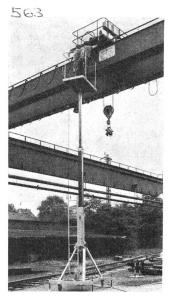
höhe beträgt 9,50 m. Bei der Bauart M geschieht das Ausschieben des Mastes teleskopartig von Hand. Über eine Leiter, die sich der Hubhöhe anpasst, wird die Plattform (max. 4,20 m) erreicht.
