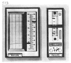
dener Industriezweige wie der chemischen, petrochemischen und stahlverarbeitenden Industrie. Die Frontrahmen der kompakten, transistorisierten Einheiten sind nur 48×144 mm gross und erlauben damit eine optimale Ausnutzung der zur Verfügung stehenden Schalttafel-Front. Sämtliche Regler besitzen eigensichere Ein- und Ausgangsschaltungen und sind für eine praktisch stossfreie Umschaltung beim Wechseln von manuellen auf automatischen Betrieb und umgekehrt ausgelegt. (Philips AG, Zürich)
