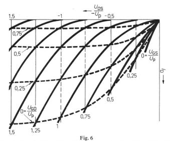
Konstruktion des Rückwärtskennlinienfeldes aus dem Vorwärtskennlinienfeld Im gestrichelten zum ersten Quadranten zentralsymmetrischen Kennlinienfeld ist  $U_{\mathrm{GD}}$  Parameter. Man findet die gesuchten, ausgezogenen Kennlinien mit  $U_{\mathrm{GS}}$  als Parameter, indem man die Punkte sucht, die Gl. (8) erfüllen
