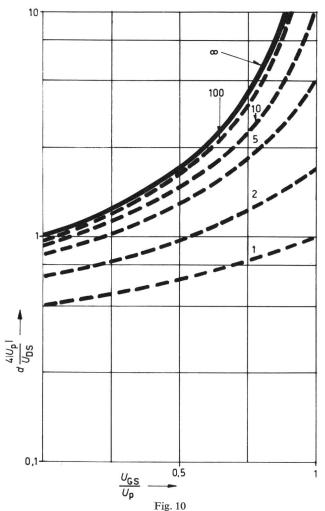
Theoretischer Verlauf des Klirrfaktors [Gl.(9)] der Schaltung in Fig. 8a in Funktion von  $U_{\rm GS}/U_{\rm p}$  Parameter:  $R/r_{\rm DSS}$
