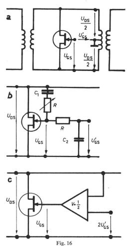
Mögliche Schaltungen zur Linearisierung des FET Kennlinienfeldes a mit symmetrischen Transformator; b mit Kondensatorkopplung; c mit Trennverstärker
