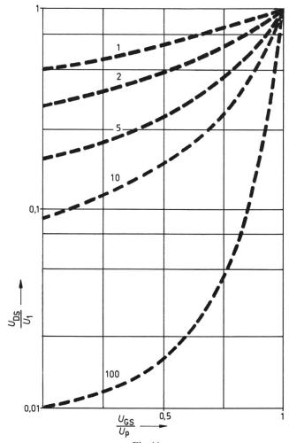
Fig. 11 Abschwächung des Spannungsteilers in Fig. 8a in Funktion von  $U_{\rm GS}/U_{\rm p}$  Parameter:  $R/r_{\rm DSS}$
