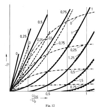
Kennlinien der Antiparalleischaltung von 2 identischen FET Parameter:  $U_{\rm GS}/U_{\rm p}$ . Durch Addition der Ströme der beiden FET (gestrichelt) erhält man das gesuchte Kennlinienfeld
