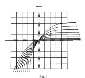
Kennlinienfeld des Feldeffekttransistors MPF 103 im 1. und 3. Quadranten
