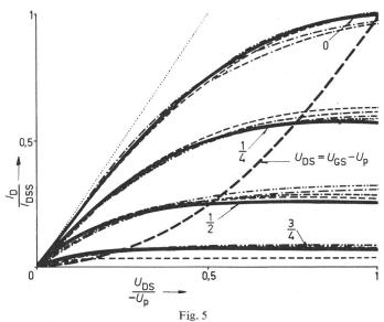
Kennlinien im ersten Quadranten normiert auf  $I_{\rm DSS}$  und  $U_{\rm p}$  Parameter ist die auf  $U_{\rm p}$  normierte Gatespannung  $U_{\rm GS}$ . Gestrichelt eingezeichnet sind vier gemessene Kurven für verschiedene FET, ausgezogen der Verlauf der mathematischen Approximation nach Gl. (5)
