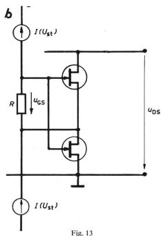
Möglichkeiten zur Ansteuerung der Gate-Sourcestrecke, die nicht geerdet ist a bei Antiparallelschaltung
