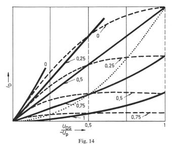
Konstruktion des durch «Gegenkopplung» linearisierten Kennlinienfeldes Man findet es, indem man im ursprünglichen Kennlinienfeld (gestrichelt) den Drainstrom  $I_{\rm D}$  für die nach Gl. (13) veränderte Gatespannung sucht. Parameter:  $U_{\rm GS}/U_{\rm p}$
