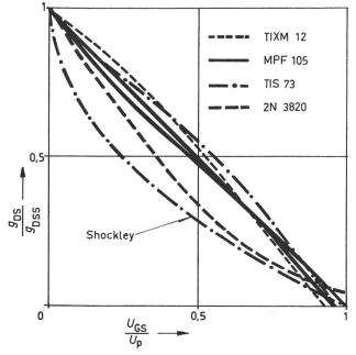
Fig. 4 **Dynamischer Leitwert im Nullpunkt in Funktion von**  $U_{\rm GS}/U_{\rm p}$  Eingezeichnet sind Gl. (1) und (2) sowie gemessene Kurven für vier verschiedene FET
