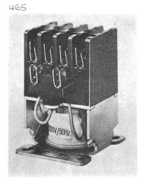
4-polige Ausführung des Schalters mit Schliess- und Öffnungskontakten ermöglicht eine Vielzahl von Schaltfunktionen. Die Konstruktion erlaubt auch eine Änderung der Schaltfunktionen am Montageort ohne besondere Werkzeuge. Der Anschluss kann als Doppelsteckanschluss mit AMP-Steckkabelschuh 6,3 mm oder als Schraubanschluss für Leiter bis 2,5 mm² mit Schrauben M3 ausgeführt werden.
