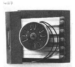
bezogen auf 1 U./min. Die Leistungsaufnahme beträgt nur 0,25 VA bei 24 V, 50 Hz. Durch Vorschalten eines Kondensators von 0,15  $\mu$ F kann der Motor auch direkt ans Netz 220 V, 50 Hz, angeschlossen werden.
