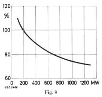
Die relativen Baukosten der Dampfkraftanlagen je nach der Einheitsleistung der Maschinensätze
