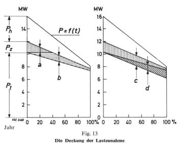
links: mittels neuer Spitzenwerke; rechts: mittels neuer Grundlastwerke;  $P=\mathbf{f}(t)$  vereinfachte Jahresdauerkurve;  $P_{\mathbf{t}}$  Last der Dampfkraftwerke;  $P_{\mathbf{h}}$  Last der Wasserkraftwerke;  $P_{\mathbf{z}}$  Lastzunahme (zwischen den Lastzonen der thermischen und hydraulischen Leistung eingetragen); a Auslastung der neuen Spitzenwerke; b Auslastung der älteren Dampfkraftwerke; c Auslastung der neuen Dampfkraftwerke; c Auslastung der älteren Dampfkraftwerke
