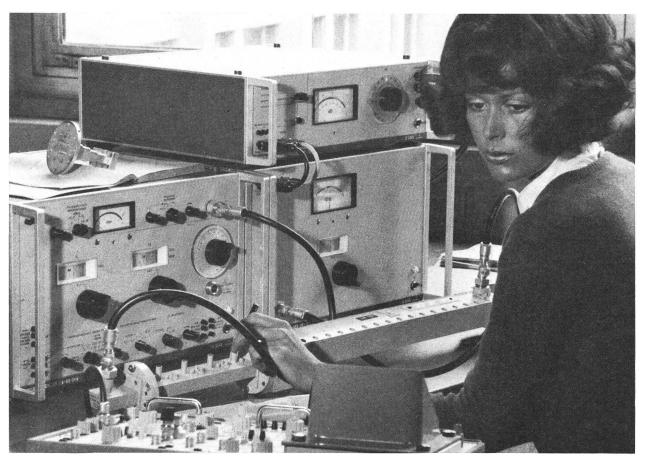
Abgleich eines Hohlleiterfilters mit einem Wobbelmessplatz
