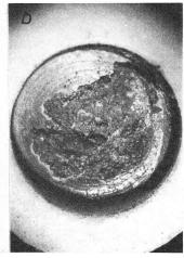
Fig. 3 **Korrodierte Kontakte** *a* Leuchte; *b* Lampe
