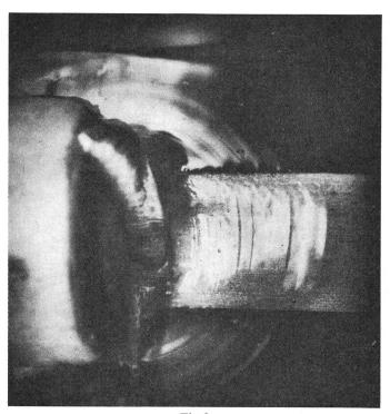
Fig. 2 Bruch in der Verschmelzung
