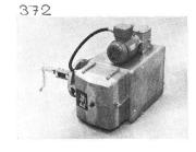
Kurzschlussankermotor für den Antrieb der Füllhöhenmess-Einrichtung. Die Drehrichtung desselben wird durch einen Magnetschalter und zwei Schaltschütze gesteuert. Magnetschalter für Zählwerk, Magnetschalter zum Einstellen der Messbandlänge, Endschalter (Mikro-Schalter), Steuer- und Netzanschlussklemmen 3 P+N+E eingebaut.
