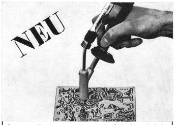
Grosse Zeitersparnis und Arbeitserleichterung mit ZEVA-Vakuum-Lötkolben beim Auslöten von Bauteilen auf gedruckten Schaltungen. Keine thermische oder mechanische Beschädigung der Bauteile oder Platten. Bohrungen oder Lötösen bleiben geöffnet. Modelle für Werkstatt, Labor oder Reparaturservice. Verlangen Sie bitte unsere Unterlagen.
