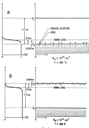
Fig. 9 Die Energie-Verhältnisse für p- und n-dotiertes Silizium
