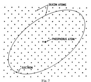
Schematische Darstellung eines Si-Kristalles mit einem Phosphor-Fremdatom (Donor)
