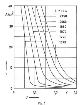
Strom-Spannungskennlinien einer Plasma-Diode
