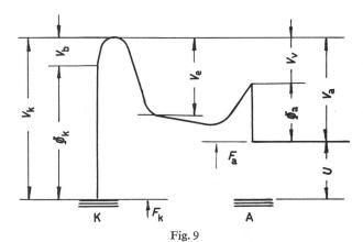
$\label{eq:potentialdiagramm} \begin{array}{c} \textbf{Potentialdiagramm der Plasma-Diode} \\ U \ \text{Ausgangsspannung;} \ \ V_{\text{b}} \ \text{Potentialbarriere am Emitter;} \ \ V_{\text{e}} \ \text{Potentialsenke;} \ \ V_{\text{v}} \ \text{Potentialverlust im Plasmaraum} \\ \text{Weitere Bezeichnungen siehe Fig. 2 und 3} \end{array}$
