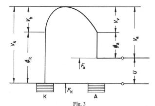
Potentialdiagramm des thermionischen Vakuumgerätes  $F_{\mathbf{k}}$  und  $F_{\mathbf{a}}$  Potentialebenen der Elektroden; U Nutzpotential;
