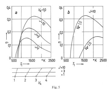
(errechnete Werte) a bei verschiedener Stromdichte  $J;\ b$  bei verschiedener Austrittsarbeit der Anode  $V_{\rm k}$  Potentialanstieg bei der Kathode;  $V_{\rm a}$  Potentialabfall bei der Anode;  $\eta$  Wirkungsgrad
