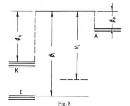
Theoretische Potentialebenen in der Plasma-Triode I Ionisationselektrode;  $V_i$  Potential der Kontaktionisation;  $\Phi_i$  Austrittspotential der Ionisationselektrode Weitere Bezeichnungen siehe Fig. 1 und 2
