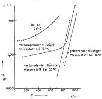
Fig. 1 Verlustfaktor tg  $\delta$  bei verschiedener Feldstärke E
