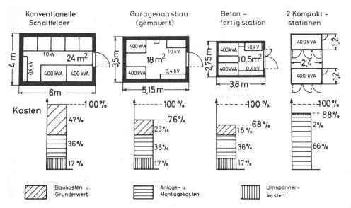
recht kompliziert. Dies gilt insbesondere dann, wenn Kabelabgänge nicht in einer Ebene zur Front- oder Rückseite der Anlage installiert werden. Eine Gefahr bei Kompaktanlagen liegt auch darin, dass Kontakte und Verbindungen sehr eng nebeneinander liegen. Beim Ausphasen, bei anderen Prüfund Montagearbeiten muss deshalb sehr sorgsam darauf geachtet werden, dass keine Überschläge auftreten können und dass vor allem kein anderes Gerät als die Spezialwerkzeuge verwendet werden.
