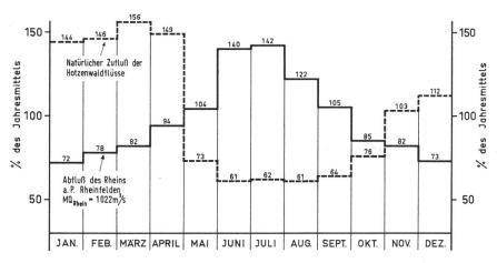
Damit ist sichergestellt, dass der Jahresspeicher Lindau immer gefüllt werden kann, entweder durch die natürlichen Zuflüsse aus dem Schwarzwald, die besonders im Herbst und Frühjahr ihr Hochwasser führen, oder durch die Pumpwasserentnahme aus dem Rhein, der besonders im Sommer die Schmelzwässer aus den Alpen abführt.
