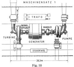
Grundriss eines Maschinensatzes
