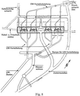
Lageplan des Kavernenkraftwerkes Säckingen Länge der Maschinenkaverne 160 m
