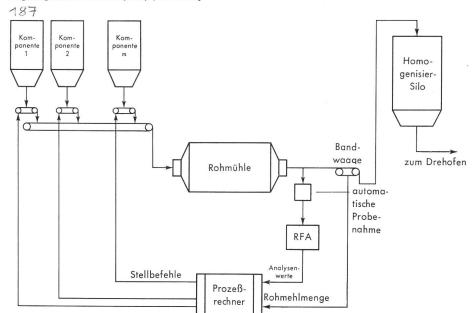
Der Einsatz von Prozessrechnern in Verbindung mit neuen Analysengeräten schafft die Voraussetzungen für die Automatisierung mechanischer Mischprozesse mehrerer Materialkomponenten und gewährleistet die Einhaltung bestimmter Spezifikationen der Mischung bezüglich ihrer chemischen Zusammensetzung. Die Methode der Röntgenfluoreszenz-Analyse liefert innerhalb
