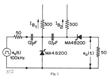
Impulsformungs-Schaltung mit ladungsgesteuerten Dioden
