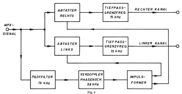
Blockschema zur Decodierung des Multiplexsignals nach dem Abtastverfahren (Zeitmultiplexdecoder mit Abtastung)
