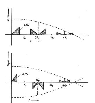
Fig. 6 Spektraldichteverteilung der abgetasteten Folgen  $M_1(f)$  und  $M_2(f)$  bei einer willkürlich gewählten Impulsbreite  $(\beta/T_0{\approx}0,4)$
