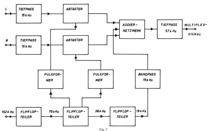
Blockschema zur Codierung nach dem Zeitmultiplexverfahren mit Abtastimpulsen der Länge  $\beta=0,6033~T_0$ Bezeichnungen siehe Fig. 1
