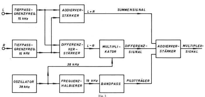
Blockschema zur Erzeugung des Multiplexsignals nach dem Matrixverfahren (Matrixcoder)
