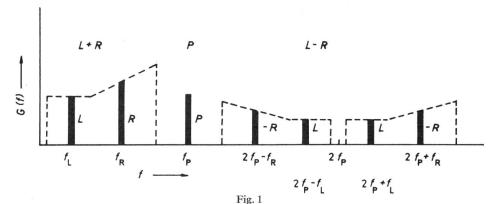
Spektrum des Multiplexsignals mit den Enveloppen des kompatiblen Spektrums L+R und des Zusatzspektrums L-R
