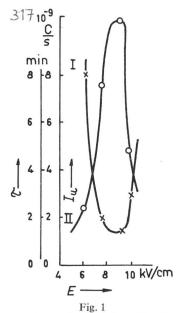
Abhängigkeit der Lebensdauer  $\tau$  der Abdeckung (I) und der relativen Intensität der Teilentladungen  $I_{\mathfrak{U}}$  (II) ovn der elektr. Feldstärke EDie Elektroden sind mit einer Lage Kondensatorenpapier abgedeckt
