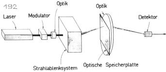
Fig. 1 Prinzip der optischen Speichertechnik
