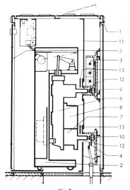
Fig. 7 Schalterzelle Isokompact für 12 und 24 kV
