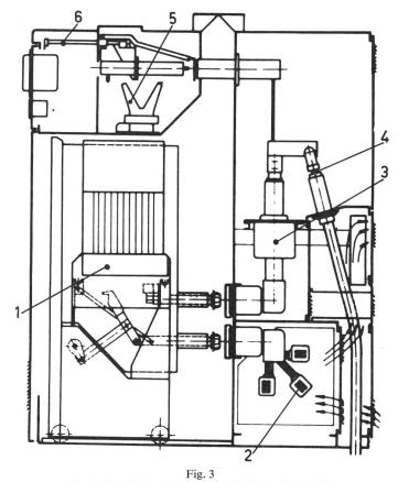
Geschottete Zelle mit Magnet-Luft-Schalter für 7,2 kV
