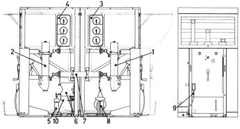
Fig. 10 2stöckiges Doppelsammelschienen-Schalterfeld Ölstrahlschaltern für 12 und 24 kV
