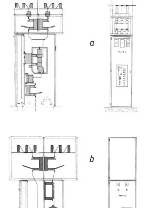
Fig. 13 Schalterfeld mit Trenner und festeingebautem ölarmem Schalter und Doppelsammelschiene
