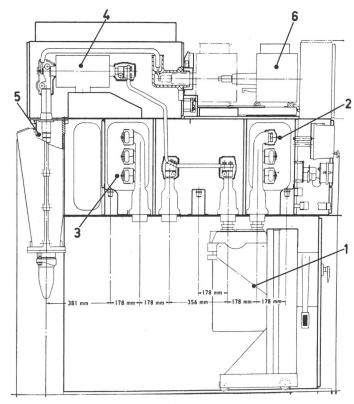
Fig. 5 Schnittbild durch eine Schalterzelle mit Vertikaltrennung und Doppelsammelschiene für 11 kV und 350 MVA
