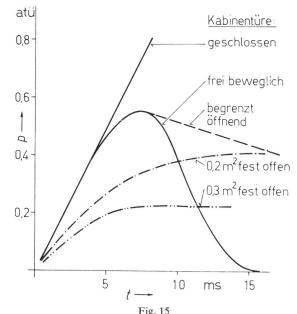
Druckverlauf in einer Schalterzelle in Funktion der Zeit unter Lichtbogeneinwirkung Kabinenvolumen 12 m $^3$ ;  $I_{\rm eff}=20~{\rm kA}$
