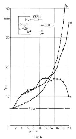
Kritische Schlagweiten  $s_{x,k}$  eines 20stufigen, 4-MV-, 300-kWs-Generators bei verschiedenen Belastungsverhältnissen
