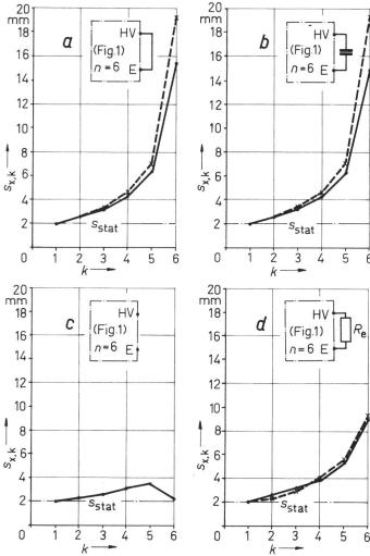
Fig. 3 Kritische Schlagweiten  $s_{x,k}$ eines 6stufigen Stossgenerators bei verschiedenen Belastungsverhältnissen
