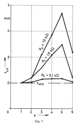
Die kritischen Schlagweiten  $s_{\rm X,k}$ eines 6stufigen Generators bei verschiedenen Entladewiderständen  $R_{\rm e}$
