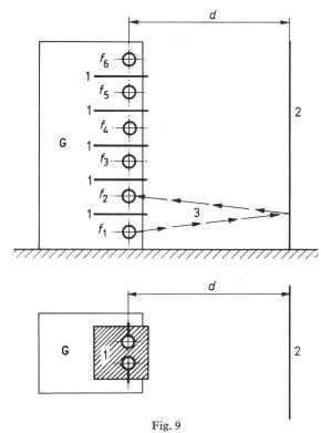
Versuchsaufbau zur Messung des Bestrahlungseinflusses der ersten Funkenstrecke auf die Zündwahrscheinlichkeit der zweiten Funkenstrecke
