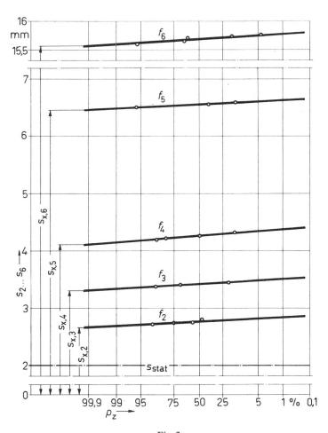
Fig. 2 Die Zündwahrscheinlichkeit der Funkenstrecken  $f_2...f_6$  eines kurzgeschlossenen 6stufigen Stoßgenerators als Funktion der Schlagweiten
