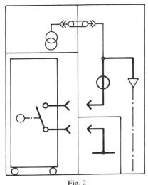
Schematische Darstellung eines geschotteten Schaltfeldes mit horizontal steckbarem Leistungsschalter
