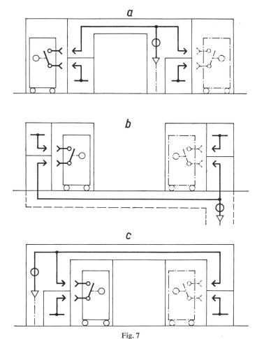
Schematische Darstellung des Zweileistungsschaltersystems (Duplex)
