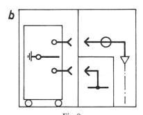
Fig. 9 Schematische Darstellung der Erdung von Abzweig oder Sammelschiene
