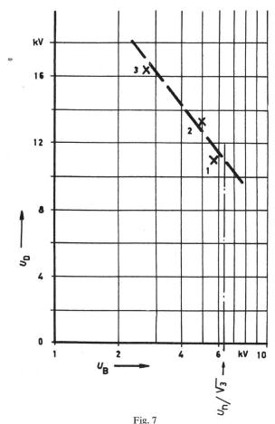
Durchschlagprüfungen an 11-kV-Statorwicklung nach 35jähriger Betriebszeit Durchschlagspannung  $U_{\mathrm{D}}$  abhängig von der örtlichen Betriebsspannung  $U_{\rm B}$  der ersten durchgeschlagenen Stäbe
