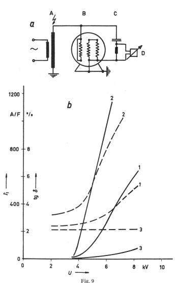
tg  $\delta$ - und Ionisationsmessungen in Abhängigkeit von der Spannung U an im Betrieb stehenden Maschinen
