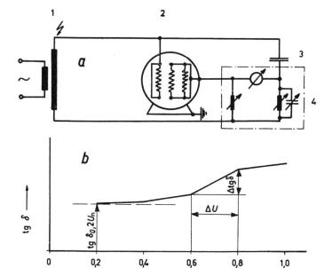
$Fig.~2\\ tg\delta\text{-Messung an Maschinenwicklungen}$
