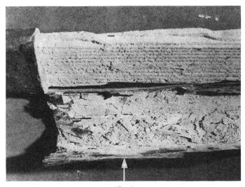
Fig. 6 Roebelstab eines 11-kV-Generators, isoliert mit Schellackmicafolium, nach 35jähriger Betriebszeit
