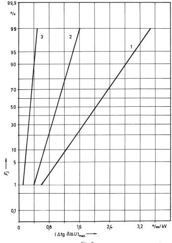
Fig. 3 Summenhäufigkeit  $F_{\rm j}$  der maximalen Anstiegswerte  $(\Delta {\rm tg} \delta/\Delta U)_{\rm max}$  einbaubereiter Wicklungsstäbe
