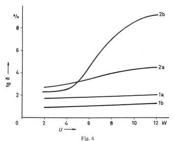
tg  $\delta$  in Funktion der Meßspannung U bei eingebauten Wicklungen im Neuzustand und nach jahrelangem Betrieb
