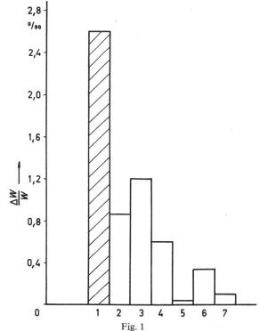
Energieausfall  $\Delta W/W$  durch Fehler an elektrischen Anlagen [1]
