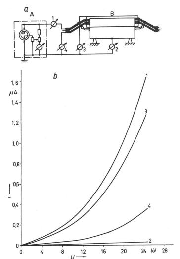
Fig. 12 Messung der Teilströme an einem Wicklungsmodell
