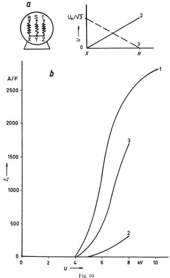
Ionisationskurven einer Maschinenwicklung 32 MVA/12-kV-Generator, Asphaltmicafolium
