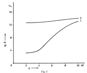
tg  $\delta$  in Funktion der Meßspannung U bei eingebauten Wicklungen I 32,5 MVA/10,5-kV-Generator A, Schellackmicafolium, Messung nach 31 Jahren Betrieb; 2 32,5 MVA/10,5-kV-Generator B, Schellackmicafolium, Messung nach 33 Jahren Betrieb
