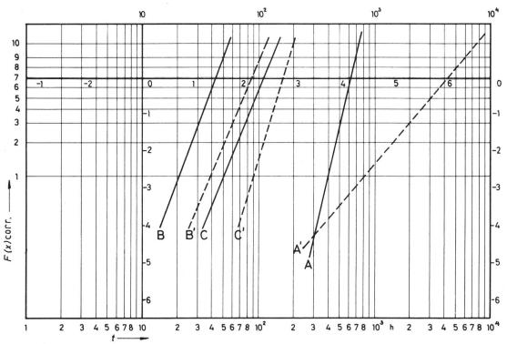
Fig. 9 Lebensdauerprüfung bei 25 V $\sim$ /µm, 50 Hz, und 115 °C von 6 Gruppen A, A', B, B', C, C' (siehe auch Tabelle IV)
