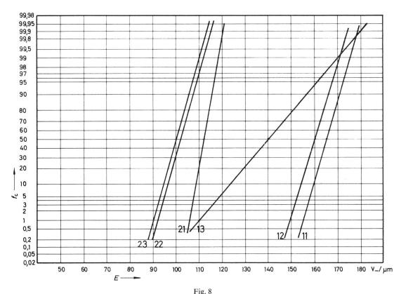
Änderung der dielektrischen Festigkeit von Papierkondensatoren (2 Lagen) bei 20 °C von mit Pyralen 1499 (Trichlordiphenyl) imprägnierten, zweilagigen Papierkondensatoren nach einer 2000stündigen Alterung unter Wechselspannung bei 115 °C
