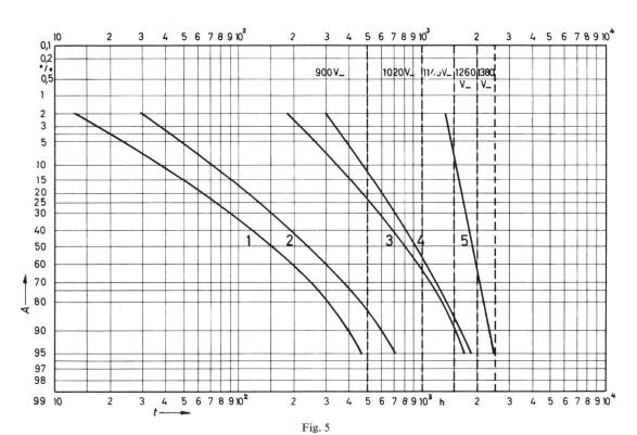
Gleichspannungslebensdauerprüfung bei 70 °C mit stufenweiser Belastung
