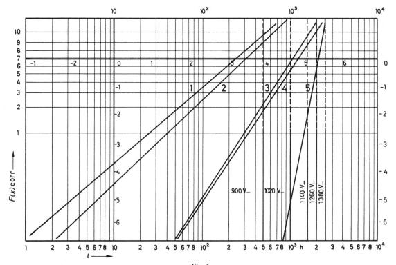
Fig. 6 Wie Fig. 5, aber Verteilung der Ausfälle in Funktion der Prüfdauer im Weibullschen Nomogramm
