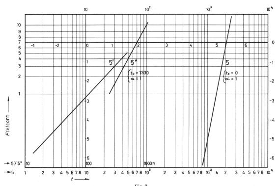
Fig. 7 Graphische Darstellung des Verhaltens der Prüfgruppe 5 aus den Fig. 5 und 6 mit dem abgeänderten Weibullschen Nomogramm Einfluss der Änderung eines Prüfungsparameters
