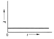
lung für die normale Arbeitsperiode f(t) Dichtefunktion;  $\lambda$  Ausfallrate bei  $t_0=0$ ;  $\alpha=1; \ \beta=1;$  t wirkliche Gebrauchsdauer
