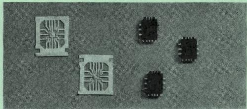
**2** Anschliessend wird dieses Subassembly in einen verzinnten Dual in Line-Rahmen geschweisst und mit einem widerstandsfähigen «ultraharten» Kunststoff verpresst, welcher in Verbindung mit der Spezialkonstruktion des Kammes den Anschlussbeinen eine ausgezeichnete Reiss- und Biegefestigkeit verleiht.
