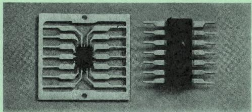
**3** Diese Verpackungsart vereinigt die Vorteile eines wirtschaftlichen Plasticgehäuses mit der Zuverlässigkeit und Qualität einer hermetischen Einbauweise. Eine klare Stempelung mit der FJ- und der 74 N-Bezeichnung vervollständigt dieses professionelle Produkt.
