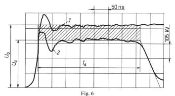
Spannungsverlauf an einer positiven Stab—Platte-Anordnung Schlagweite a = 20 cm
