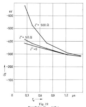
**Kennlinien**  $U_0 = f(T_d)$ Negative 10-cm-Kugel—Platte-Anordnung, Schlagweite = 22,5 cm; I' Wellenwiderstand;  $U_0$  Ursprungsspannung;  $T_{
