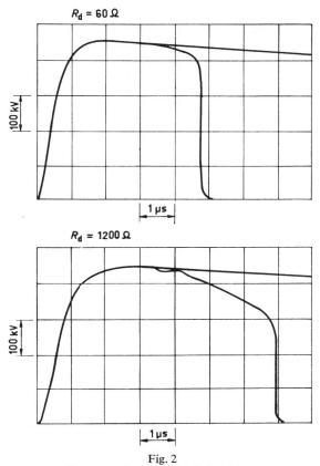
Spannungsabsenkung durch Vorströme 25-cm-Kugel—Platte-Anordnung, Schlagweite a=60 cm;  $R_{\rm d}$  Dämpfungswiderstand
