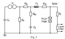
Schaltung eines Steilstossgenerators
