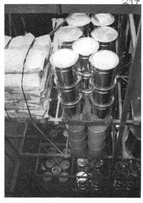
gemeinsam entwickelt wurde, sind Fässer, Säcke, Kanister etc. auf 13 Ebenen übereinander gelagert. Die Güter werden auf Paletten automatisch durch einen Computer von der Ladehalle über ein mechanisches Transportnetz und mit Hilfe von Kranen bis zu ihrem endgültigen Lagerplatz gesteuert.
