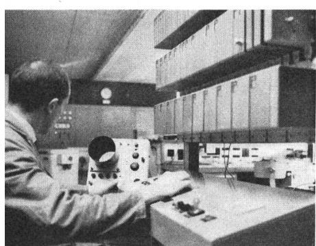
Nun – diese Steuerung enthält 15 000 Halbleiter und ist seit 22 000 Stunden in Betrieb, die andere mit 20 000 Halbleitern seit über 15 000 Stunden. Das sind insgesamt 630 Millionen Halbleiter-Betriebsstunden. Ohne Ausfall!
