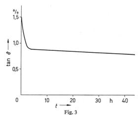
Reduktion des Verlustfaktors tan  $\delta$  beim Dielektrikum Polypropylen—Pa pier-Chlordiphenyl nach erstmaligem Einschalten
