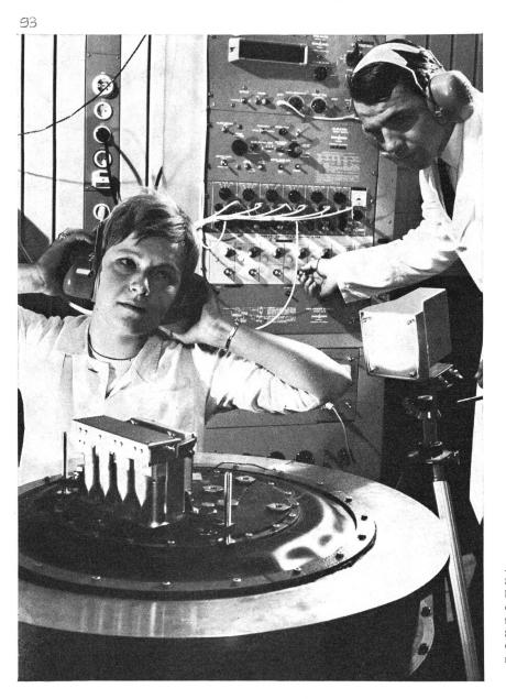
Auf diesem Schwingtisch im Zentral-Laboratorium der Siemens AG können Bauteile und auch ganze Geräte bis zu 10 000 Schwingungen pro Sekunde ausgesetzt werden. Damit lassen sich Belastungen bis zum Hundertfachen der Erdbeschleunigung (= 100 g) erreichen. Der Schwingtisch arbeitet nach dem Lautsprecher-Prinzip. Gegen den dabei entstehenden Lärm müssen sich Ingenieure und Assistentinnen mit einer kopfhörerähnlichen Konstruktion schützen.
