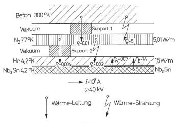
Fig. 11 Energiebilanz des Supraleitungskabels
