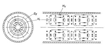
${\bf Fig.~1} \\ {\bf Das~Feldlinienbild~der}~ {\cal H}_{01} \hbox{-Welle~im~Rundhohlleiter} \\$
