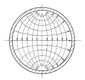
Fig. 2 Die  $H_{11}$ -Welle im Rundhohlleiter
