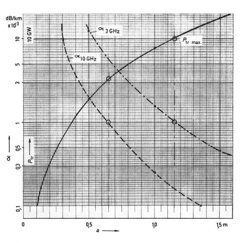
Für f = 10 GHz wäre ein Rohr von a = 0,65 m zu nehmen, jedoch wäre dann die maximale Leistung nur noch 3,4 GW.
