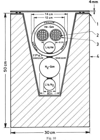
Aufbau eines Supraleitungskabels
