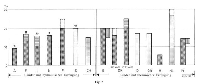
Zusammensetzung der Ausbaumargen in Prozent der höchsten Netzlast
