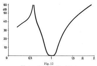
Dämpfungsverlauf des Bandfilters in Fig. 8
