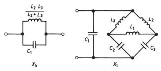
Fig. 9 Brückenzweige der Vierpolbrücke in Fig. 8
