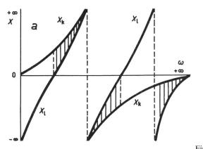
$\label{eq:Fig.10} Fig.~10$  Blindwiderstandsverlauf einer Bandsperre (a) und eines Bandfilters (b)
