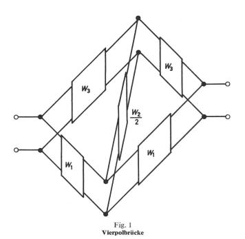
Bartlett anwenden, wobei der als «Brücke» dienende Vierpol längsgeteilt werden muss. Ist dieser Vierpol ein  $\Pi$ -Glied oder eine Brücke, so ist die Möglichkeit der Längsspaltung sofort erkennbar.
