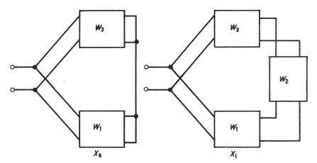
Fig. 3 Brückenzweige aus der Vierpolbrücke Fig. 1
