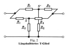
in einer abgestimmten Brücke liegt (Fig. 2), so ist es gleichgültig, ob die Sternpunkte verbunden sind (S=S') oder nicht  $(S\pm S')$ .
