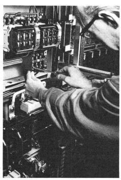
Diese und weitere Eigenschaften führen dazu, daß unsere Blockschütze überall eingebaut werden, beispielsweise in starkem Umfang in Werkzeugmaschinen-Steuerungen.
