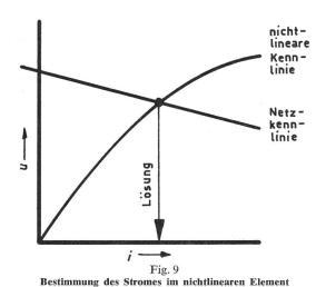
$Y_{\rm AA}^{-1}$  als Vektor z vorherberechnet. Die jeweiligen Schalterstellungen müssen dabei in der Matrix  $Y_{\rm AA}$  berücksichtigt sein, d. h. bei jedem Schalterwechsel ist z neu zu berechnen. Unter Vernachlässigung des nichtlinearen Elementes erhält man dann zunächst in bekannter Weise  $u_{\rm A\,(linear)}$  aus der Lösung von Gl. (19). Die endgültige Lösung ergibt sich durch Super-
