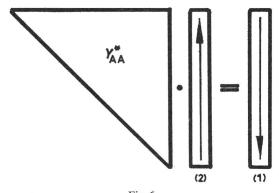
Fig. 6 Lösung linearer Gleichungen bei sich ändernden rechten Seiten einmalig: Dreieckszerlegung  $Y^*_{\Delta\Delta}$
