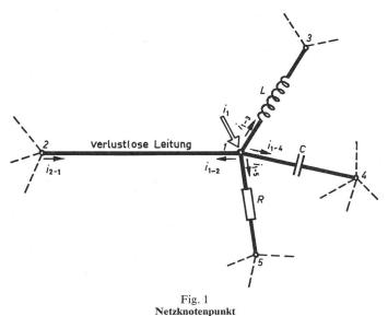
I...5 Knotenpunkte; C Kapazität;  $i_1$  Knotenpunktstrom;  $i_1.2$ ,  $i_1.3$  usw. Zweigstrom von I nach 2, I nach 3 usw.; L Induktivität; R Widerstand
