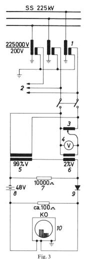
Schema für die Messung kleiner Netzspannungsänderungen
