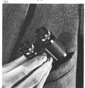
ein zweiachsiges Gelenk und kann auf Brusttaschenformat zusammengefaltet werden. Es handelt sich hiebei um ein Glas mit den optischen Daten 8×20, wobei die Zahl 8 die Vergrösserung und 20 den Objektivdurchmesser bedeutet. Man kann damit einen Gegenstand auf eine Entfernung von 80 m genau so gut erkennen, wie auf 10 m ohne Fernglas. Das Gehäuse ist aus glasfaserverstärktem Kunststoff — eine garantiert stabile und korrosionsbeständige Materialkombination, die sich in der Raumfahrt bewährt bat
